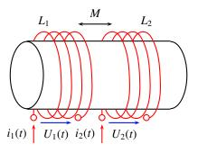
$L_1$ : Induktivität der Spule 1 : Induktivität der Spule 2 : Gegeninduktivität (Kopplung)
