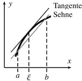
$$\exists \xi \in (a, b) \text{ mit } f'(\xi) = \frac{f(b) - f(a)}{b - a} \hat{=} \text{ mittlere Steigung} \quad (103)$$
