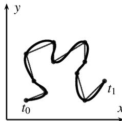
Approximation des Streckenzugs zwischen  $t_0$  und  $t_1$ .
